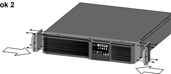
Rysunek 7 Modyfikacja zasilacza Liebert PSI na potrzeby instalacji w stojaku
