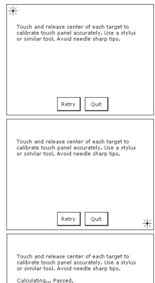
FIGURE 12-15 TOUCHSCREEN DISPLAY CALIBRATION
