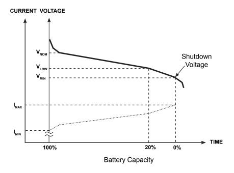
FIGURE 13.1 - TYPICAL BATTERY DISCHARGE CURVE
